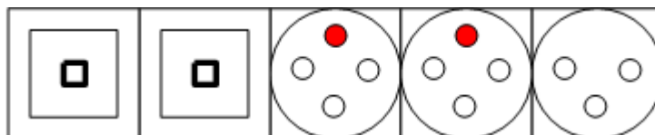
Dwa gniazda logiczne RJ45 Dwa gniazda elektryczne 230V Jedno gniazdo elektryczne 230V (oznaczone)
